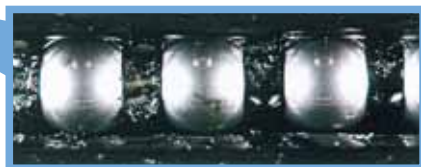
Детализация шарикового сепаратора
