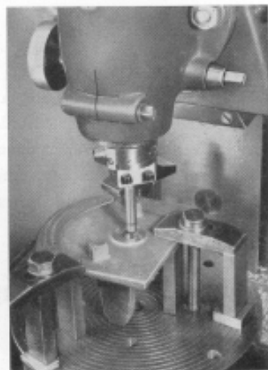
Lagerbohrung ausdrehen mit Exzenter-Ausdrehfutter
