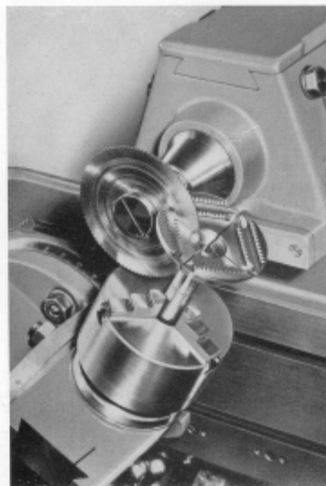
Schlitzn der Spannzange, Teilkopf 30° nach rechts geschwenkt
