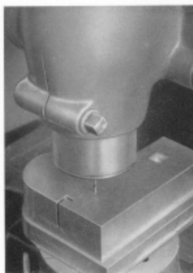
Bohren von kleinen Löchern mit Senkrecht- fräskopf
