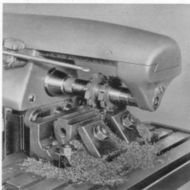
Fräsen mit Waagrechtfrässpindel und Satzfräser 2 Scheibenfräser 110 mm Ø
