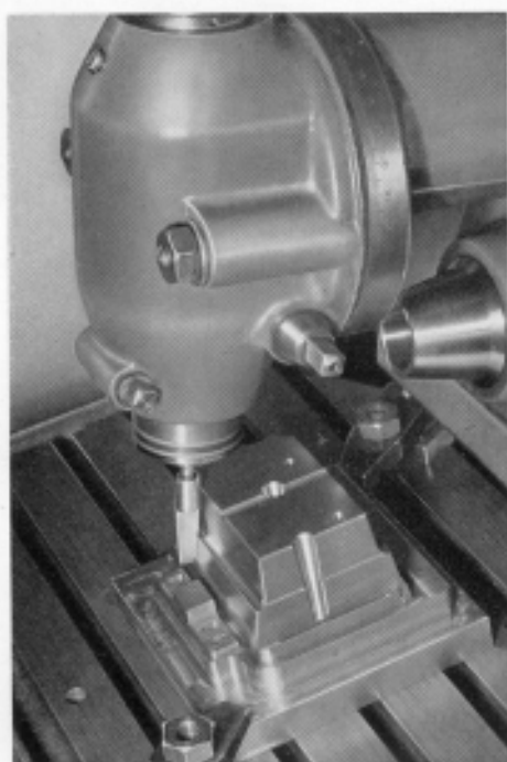
Fräsen einer schrägen Fläche mit Einschnidefräser
