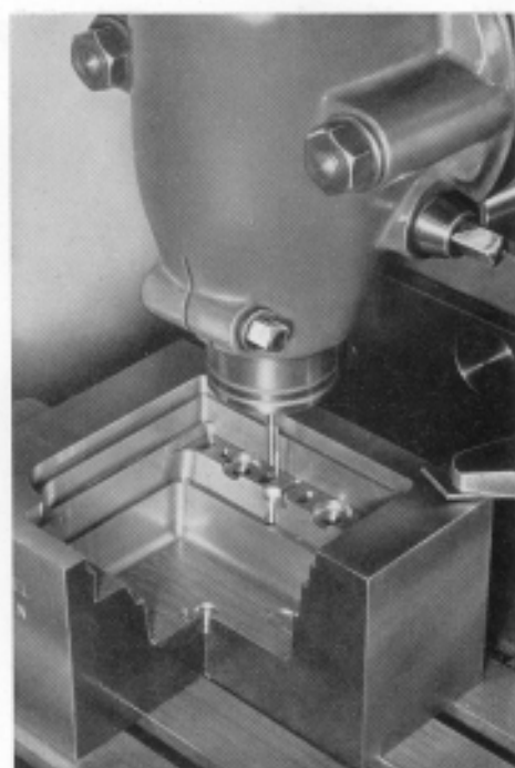
Fräsen von Schlitzten und Langlöchern mit Einschneidefräsern
