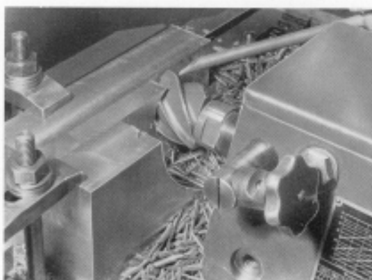
Schubbfräsung mit Walzenstirnfräser 50 mm Ø Schnitttiefe: 16 mm Vorschub: 19 mm/Min. Material: St. C. 45,61
