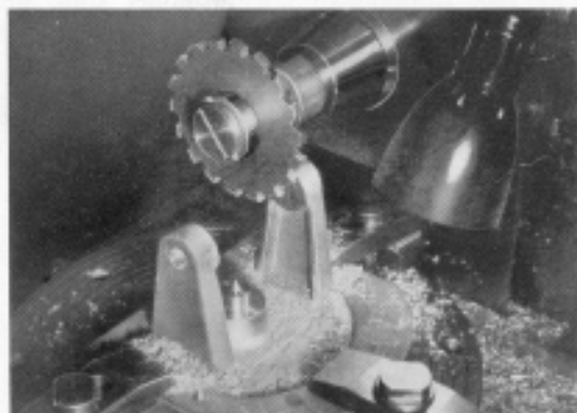
Augen-Innenflächen abfräsen mit Scheibenfräser in Waagrechtstellung
