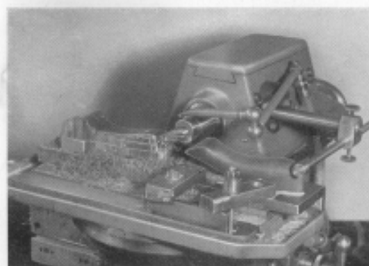
Stahlpreß-Stempel vorfräsen nach Original-Schuhleisten
