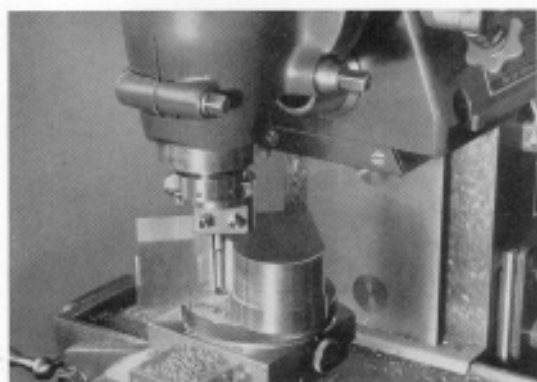
Bearbeiten der Innenrundung mit Exzenter-Ausdrehfutter
