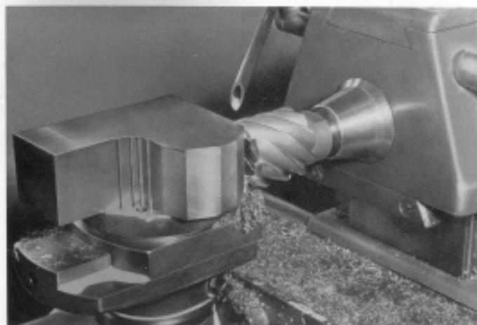
Vorfräsen mit Walzenstirnfräser 50 \times 50 \times 22 mm Der Stempel ist auf einem Schiebe- futter aufgeschraubt (Beschreibung unter „Stempelfräsen“)
