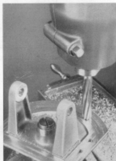
Anschraubfläche abfräsen mit Senkrechtfräskopf
