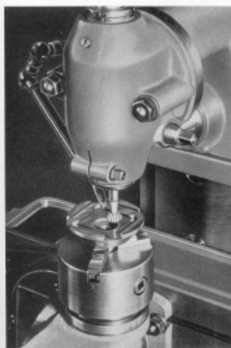
Spezialspannzange herstellen in einer Aufspannung
