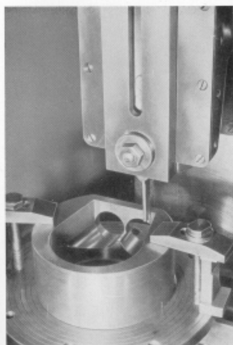
Ausstoßen von scharfen Ecken mit Stoß- apparat
