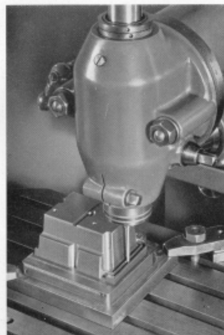
Fräsen konischer Nuten mit Einschnidefräser
