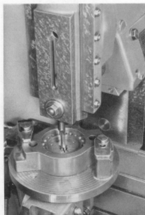
Blockschnitt-Unterteil aus Grauguß Ausstoßen von Nuten mit Stoßapparat
