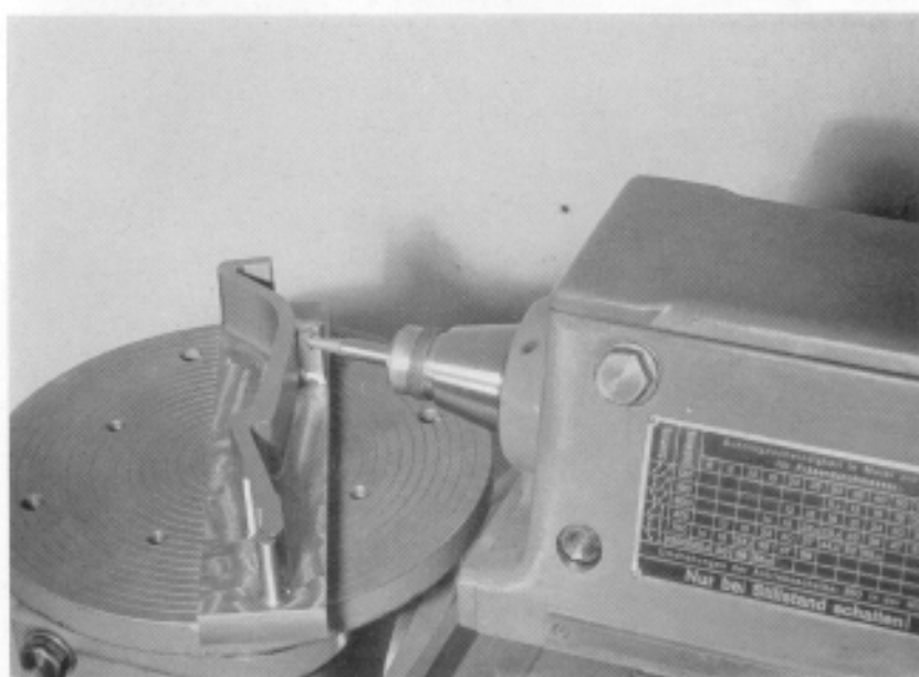
Waagrechtes Fräsen einer Innenecke mit Winkelfräser
