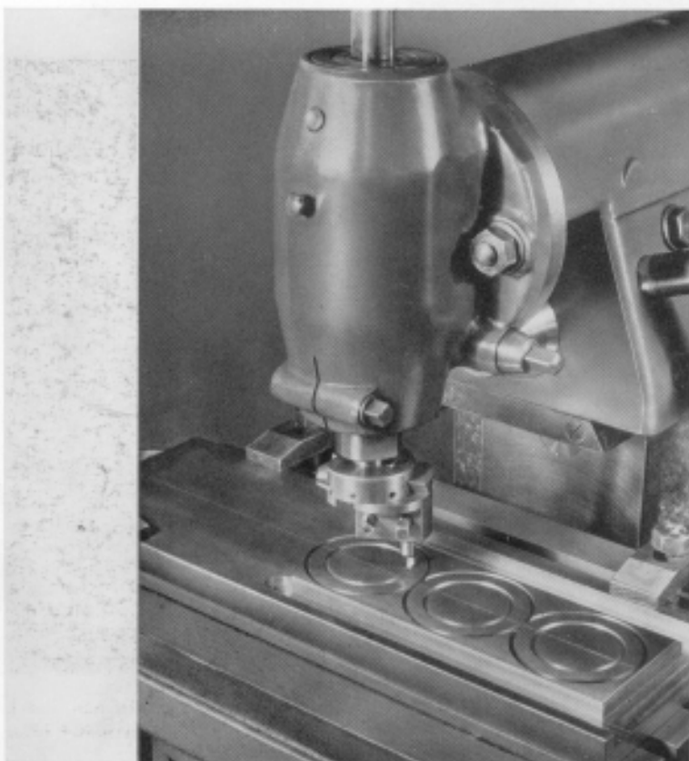
Eindrehen von konischen Rundnuten mit Exzenter-Ausdrehfutter
