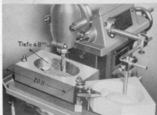
Vorfräsen einer Preßform nach einem Gipsabguß des Handmusters
