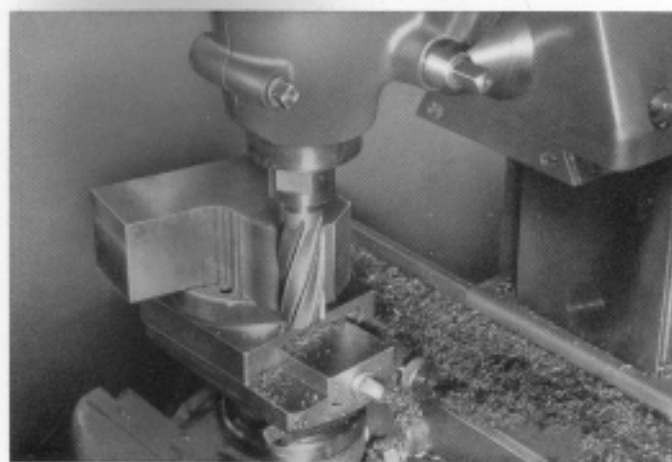
Fräsen der großen Rundung mit Schaftfräser 26 mm Ø. Der Stempel ist senkrecht gespannt
